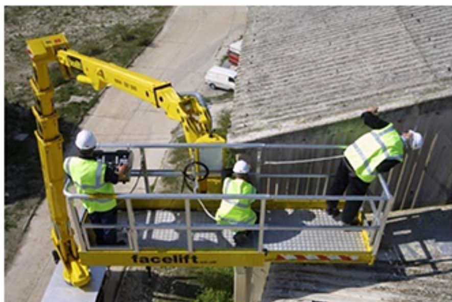
شکل ۱۱۸- بالابر سیار هیدرولیکی پشت کامیونی
